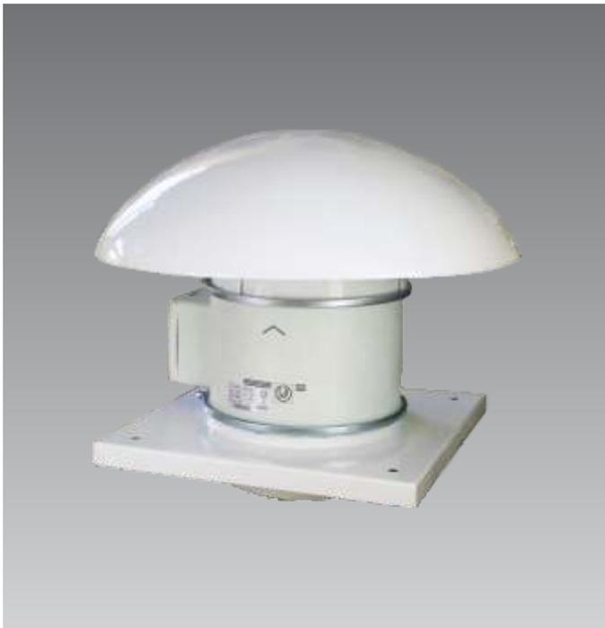
La gama de extractores de tejado helicocentrífugos de cuatro modelos 500, 800, 1300 y 2000, ofrece las características de eficiencia de los modelos TD, pero dentro de su estructura incluye una base tipo marco para su fácil instalación así como un domo que impide el paso de agua y objetos al interior, ambos fabricados en aluminio con acabado tipo poliéster termoendurecible color beige.
