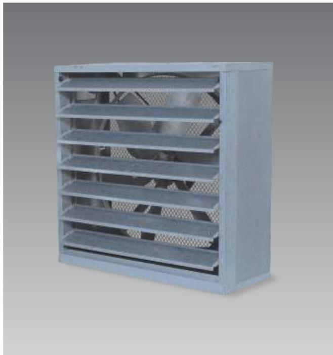
La gama AGE esta estructurada en tres tamaños, que incluyen en un sólo conjunto tipo caja: la hélice, transmisión-motor, malla de protección y persiana de apertura automática. Su diseño de alabes aerodinámicos y persiana de apertura centrífuga, agrega una máxima eficiencia de operación, debido a que la apertura de la misma no absorbe energía del sistema sino de la fuerza centrífuga que ejerce la hélice al giro.
