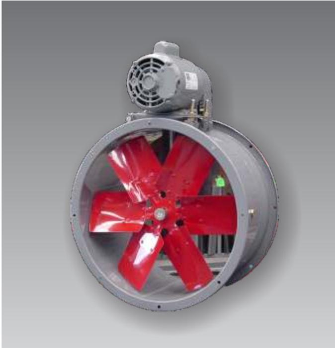
Esta gama de extractores de tipo tubular accionados por transmisión de polea y banda con motor exterior al flujo del aire, proporciona grandes prestaciones de caudal-presión para llevar a cabo la extracción de humos o gases a través de conductos.
