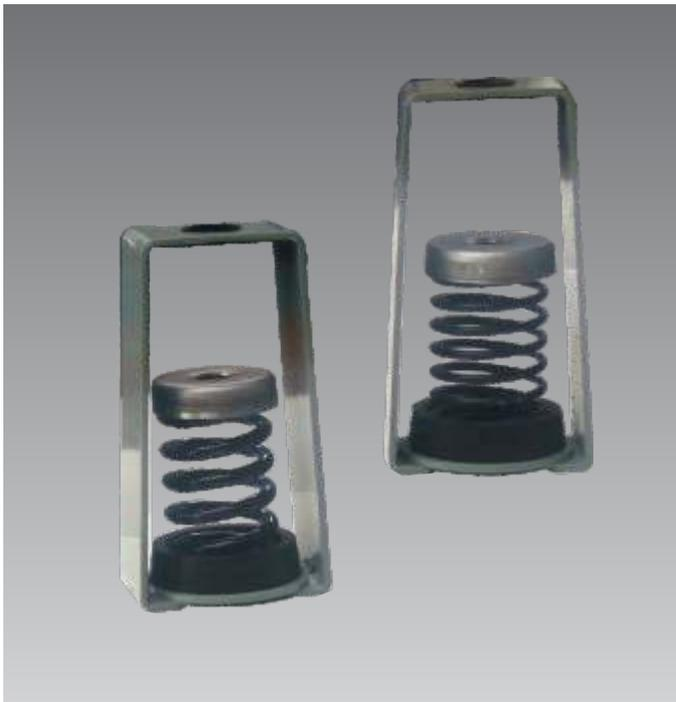
Los resortes colgantes S&P con neopreno y marco metálico, están diseñados para suspender maquinaria o equipos, aislando la instalación de cualquier vibración, absorbiendo el ruido, adecuándose a la compresión y expansión sin tensión excesiva que pueda desalinearse el sistema.
