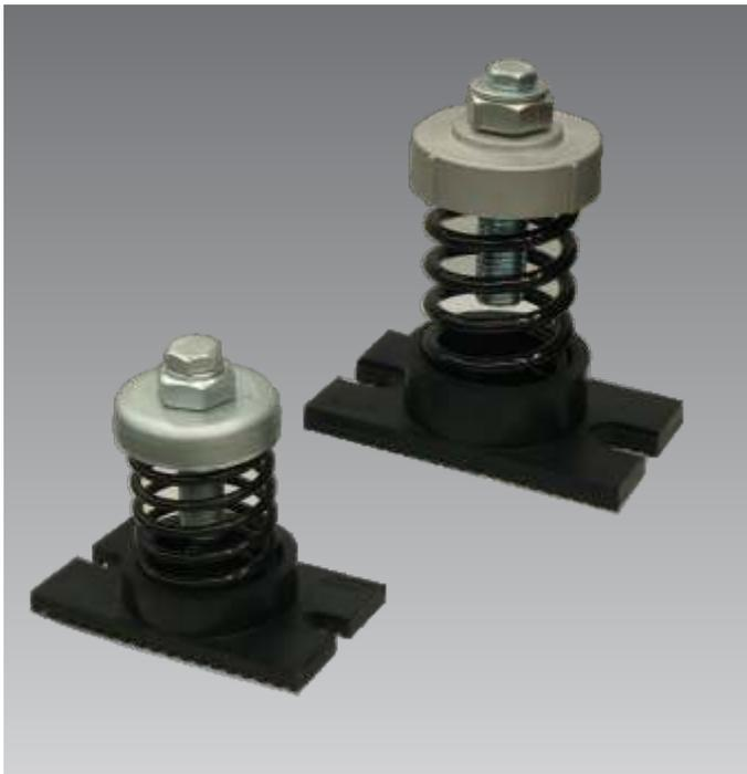
Los resortes S&P, en sus 16 opciones, están diseñados para actuar de manera independiente, para un amortiguamiento 100% vertical, son lateralmente estables sin requerir algún refuerzo. Consisten en un resorte de acero, con sistema de ajuste para controlar la deflexión (25 mm). Con base moldeada de neopreno antideslizante de 3/16" de espesor.
